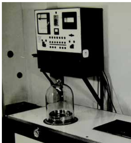
Obr. 2. Zariadenie na deštrukciu tkaniva a homogenizáciu alveolárneho vzduchu.
