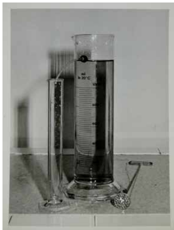
Obr. 1. Špeciálne upravený odmerný valec na zisťovanie objemu vzorky.
