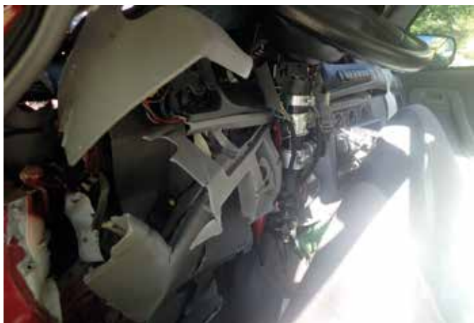
Obr. 4. Ukázka deformace interiéru vozidla č. 1.
